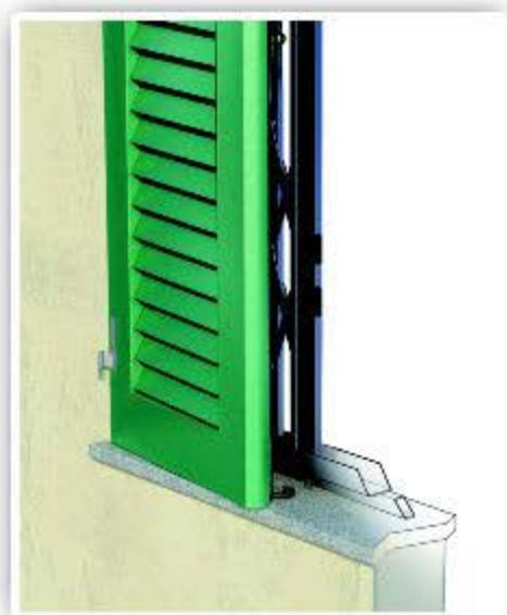
Particolare guida con spessore in presenza di gancio persiana
